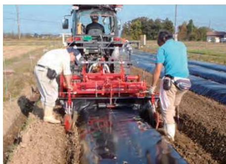
写真2 耕うん同時うね立て機でマルチ敷設
