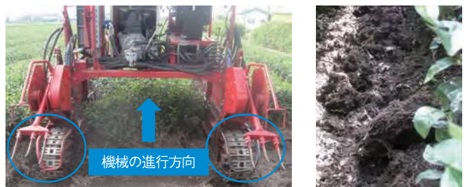
写真1 乗用型土壤反転機（左）と反転混和後のうね間土壌（右） 機械の進行方向に対して左右のテコ鋤で後方へ反転混和する
