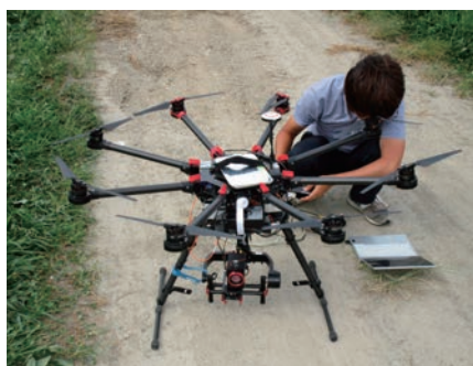
写真1 熱画像撮影カメラを搭載したドローン
